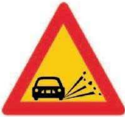
(K - 13) Επικίνδυνη εκτίναξη χαλίκων, (ασύνδετο αμμοχάλικο).
