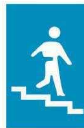
(Π - 62) Κάτω (υπόγεια) διάβαση πεζών.
